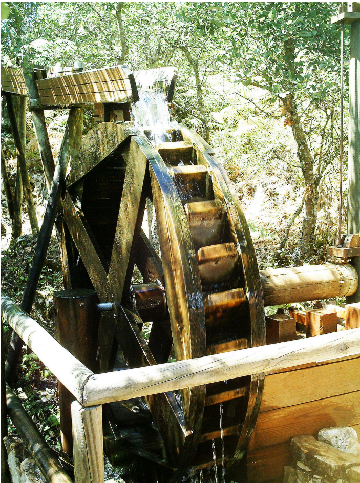
Ett överfallshjul i drift. Längst till höger syns en vinkelväxel med träpinnar. Foto från Wikipedia.
