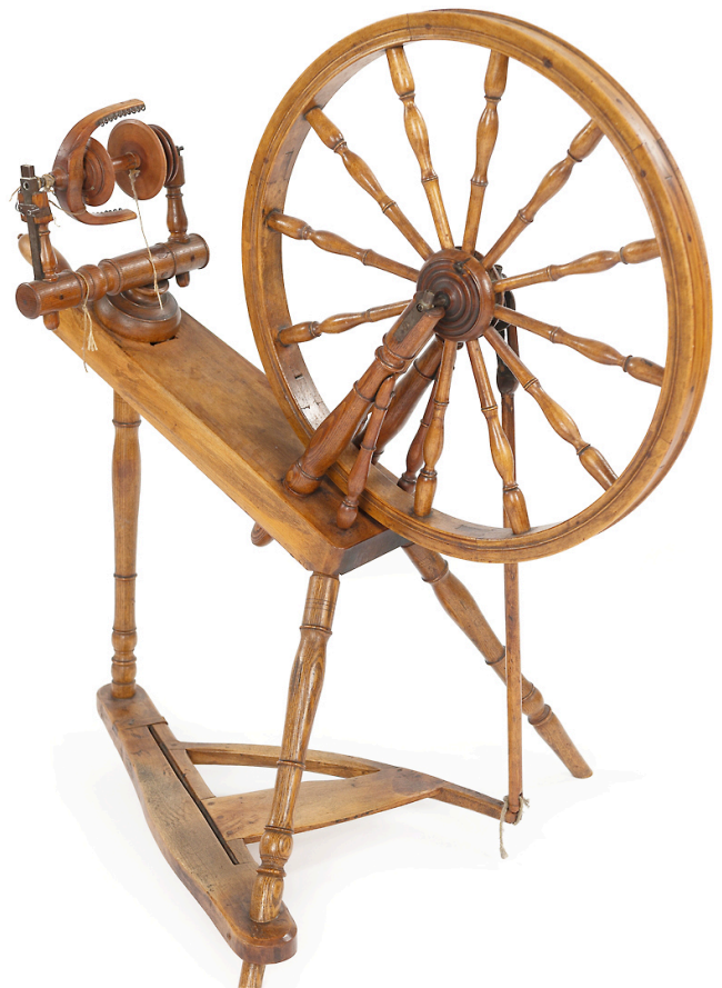
Spinnrock från slutet från 1800-talet. Med trampan drivs det stora hjulet som med trådar driver spinnanordningen till vänster. Foto Sjöhistoriska Museet.
