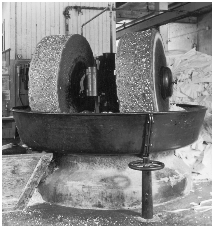
Kollergång. Pappersmassan mals genom att den vertikala axeln tvingar de två hjulen att rulla på den plana ytan. Foto Mölndals stadsmuseum.
