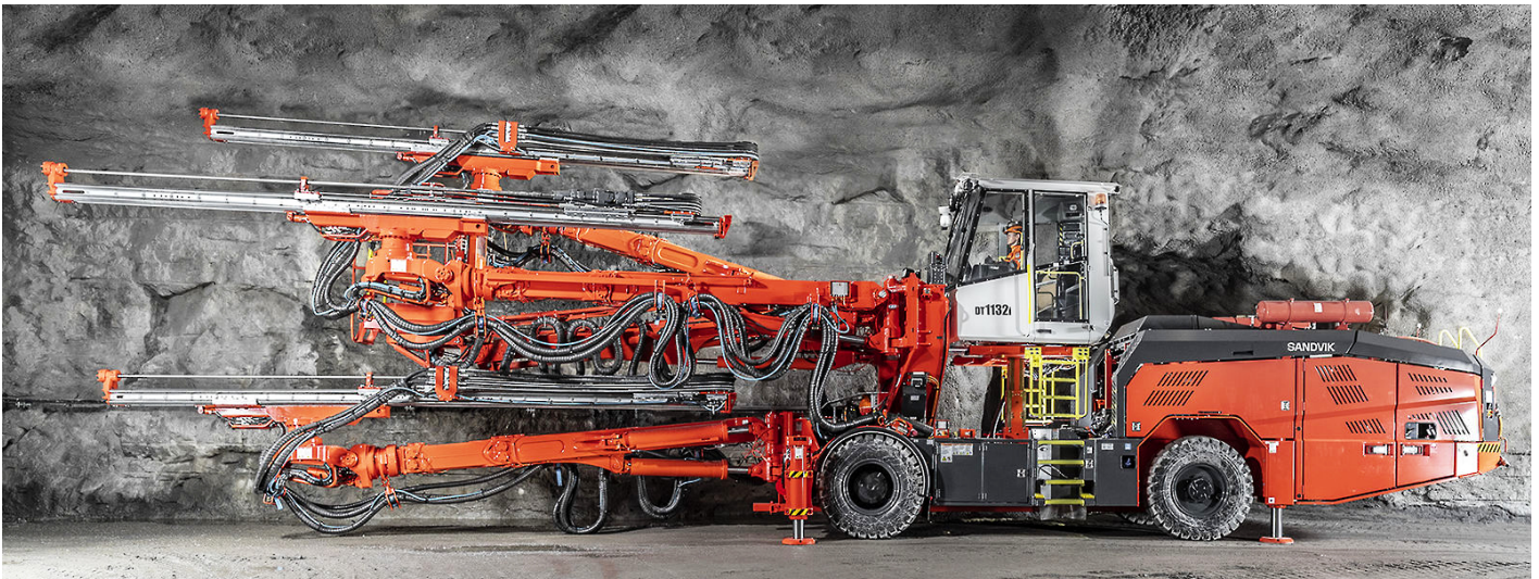
Borrugg med tre borrenheter för underjordsbruk. Foto Sandvik AB.
