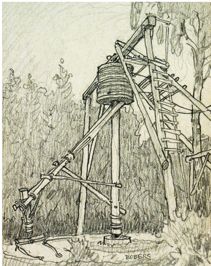
Hästvind till exempelvis en malmhiss. En häst spändes fast i seldonet och fick vandra runt medan hisslinan lindades upp på vinschtrumman. Teckning av Ferdinand Boberg 1918.
