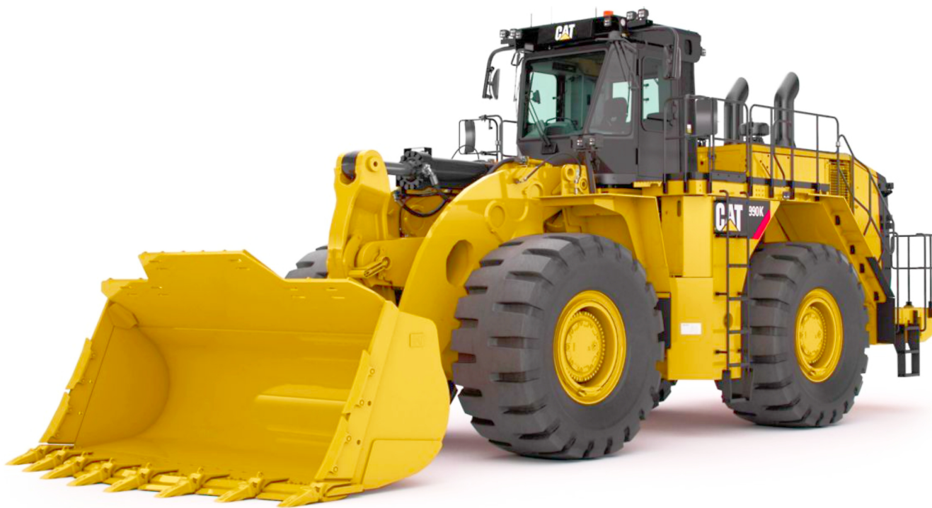
Medelstor dieselmotordriven hjullastare för dagbrott. Lastar 16 ton i skopan. Foto Caterpillar.
