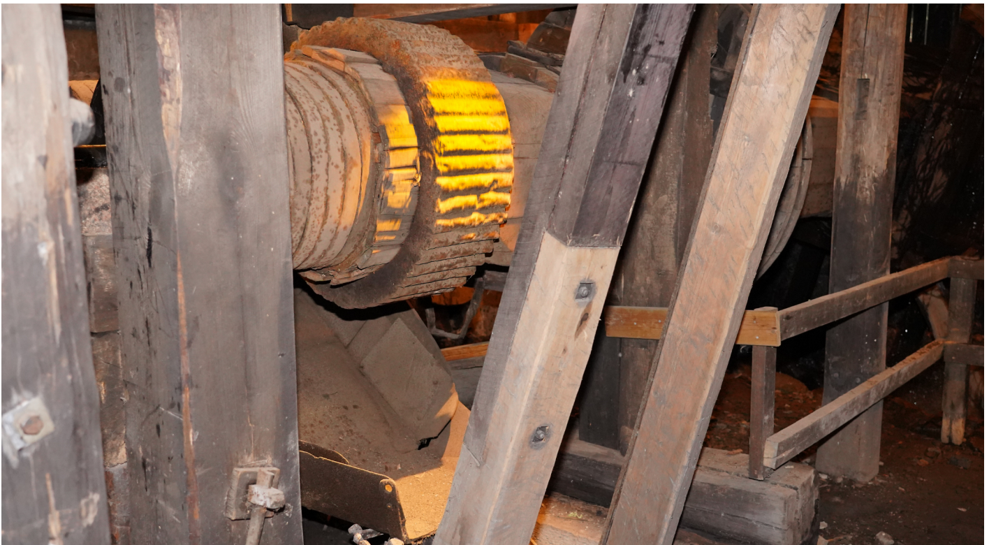
Den räfflade hjulet är ena valsen i en valskross installerad i en hytta cirka 1840. Plåtådan under valsen är en del av malmhunden, den hiss som tar upp den rostade och krossade malmen till hyttans krans (inmatningshål).
