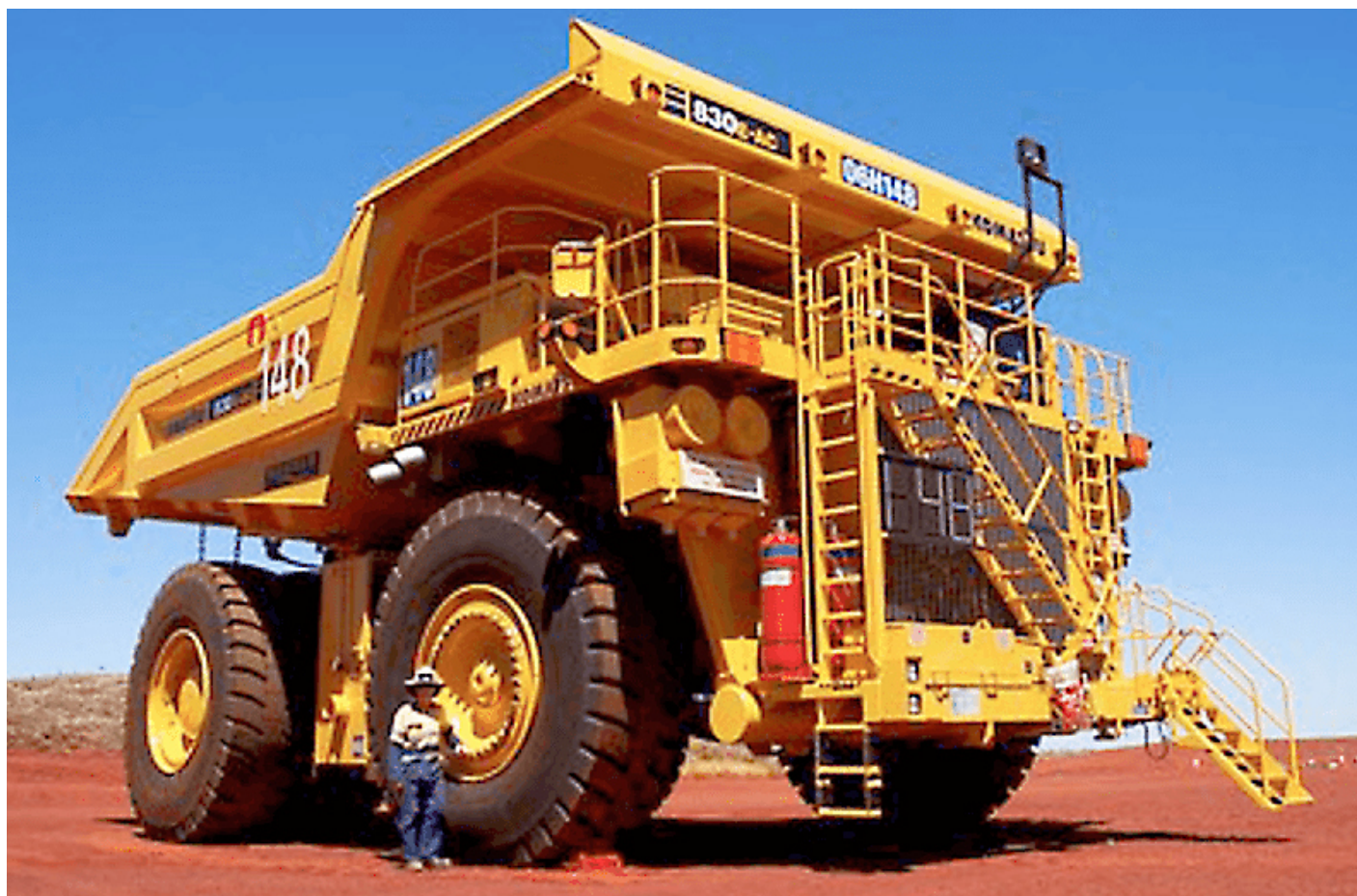
En elektriskt driven gruvtruck och förare. Trucken är avsedd för dagbrott och kan lasta 221 ton. Foto Komatsu.
