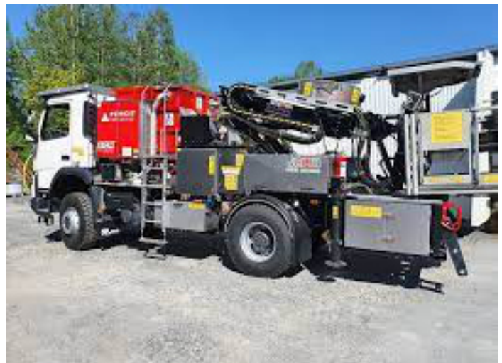
Laddtruck till underjordsgruva med takbrytning med plattform så man når upp till taket. Foto Zinkgruvan Mining.
