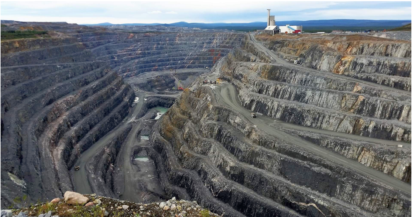
Pallbrytning vid koppargruvan i Aitik. Bild Ny Teknik.
