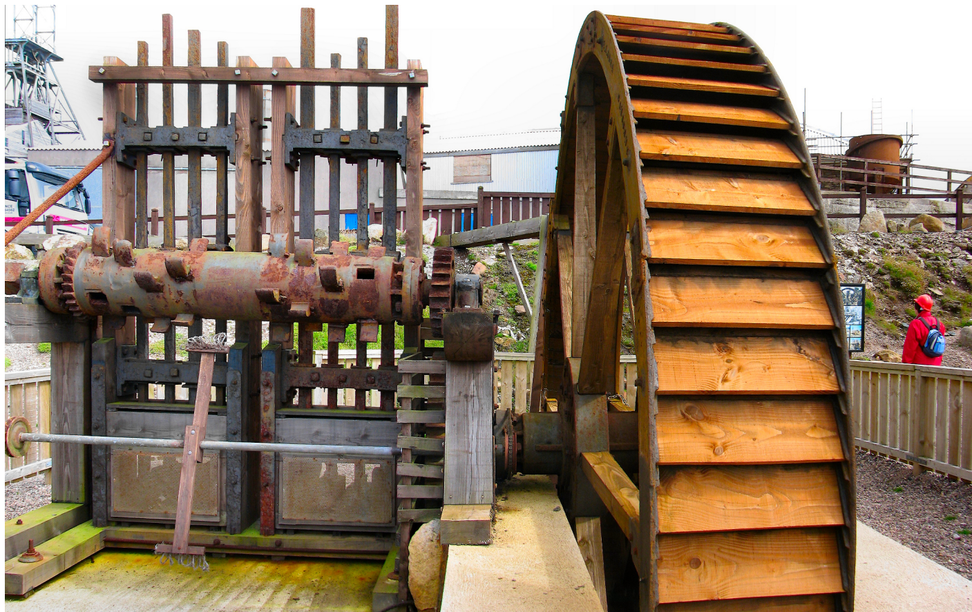
Renoverat vattenhjuldrivet stampverk med åtta stampar uppställt som ett museiföremål. Foto från Wikipedia.
