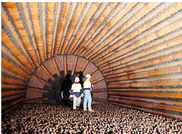
Insidan av en typisk kulkvarn. Kvarnen är här beskickad (laddad) med malm för malning. Foto Wikipedia.
