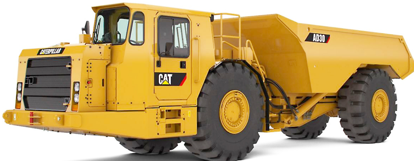
En gruvtruck för underjordsgruvor som kan lasta 30 ton. Foto Caterpillar.
