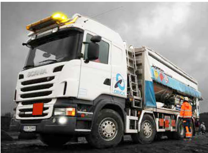
Laddtruck avsedd att leverera stora mängder sprängämne till exempelvis dagbrott. Foto Orica Sweden AB.
