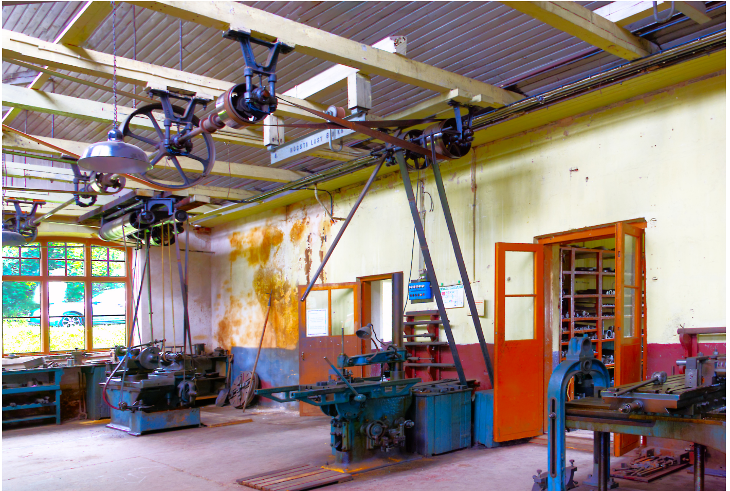
Södra delen av verkstadshallen med de äldre verktygsmaskinerna samt centraltransmissionen i taket. Den vänstra dörren leder in till maskinrummet och den högra dörren leder in till verktygsavdelningen.
