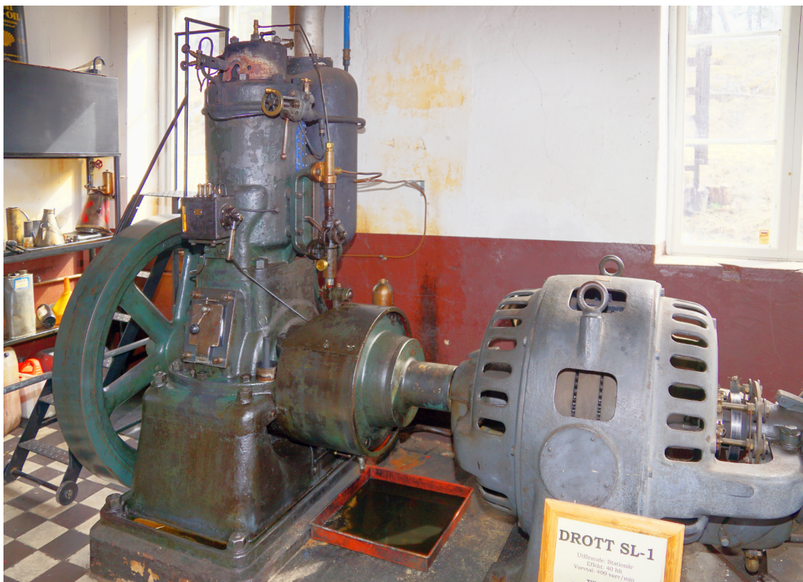
Pythagoras elverk drivs av en encylindrig Drott-motor som lämnar 40 hästkrafter vid 400 varv per minut.
