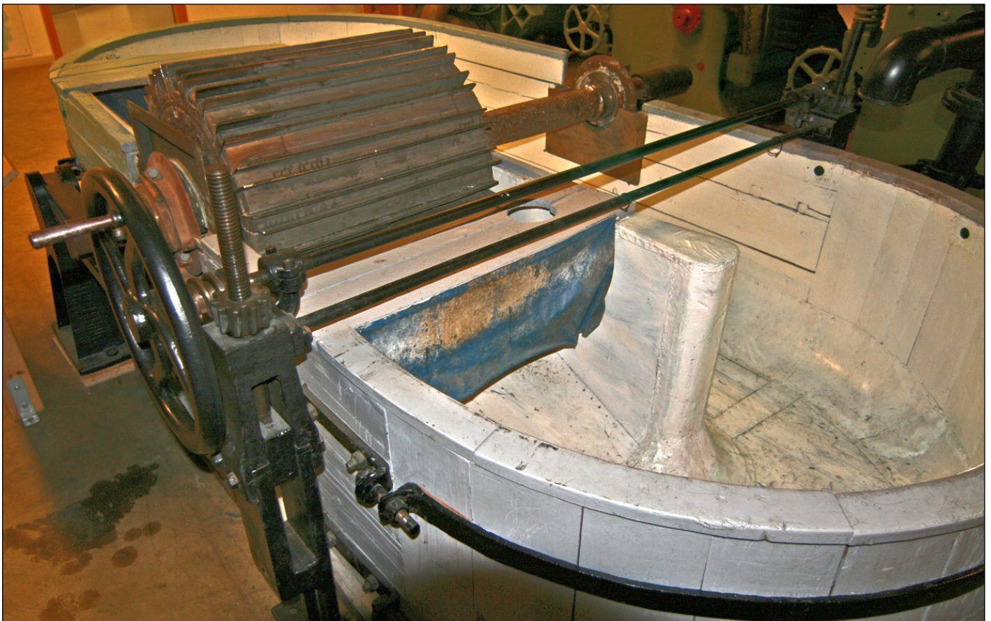
En holländare. Den roterande valsen med knivarna till vänster i bilden, de fasta knivarna ligger i botten av kanalen i vilken massan pumpas runt. Foto från Wikipedia.
