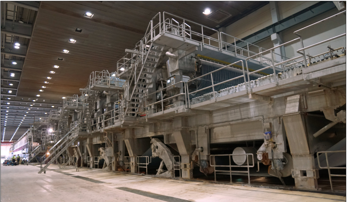
Kartongmaskin KM 8, en av världens största, vid Skoghalls bruk. Här tillverkas kartong för mjölk- och juiceförpackningar.
