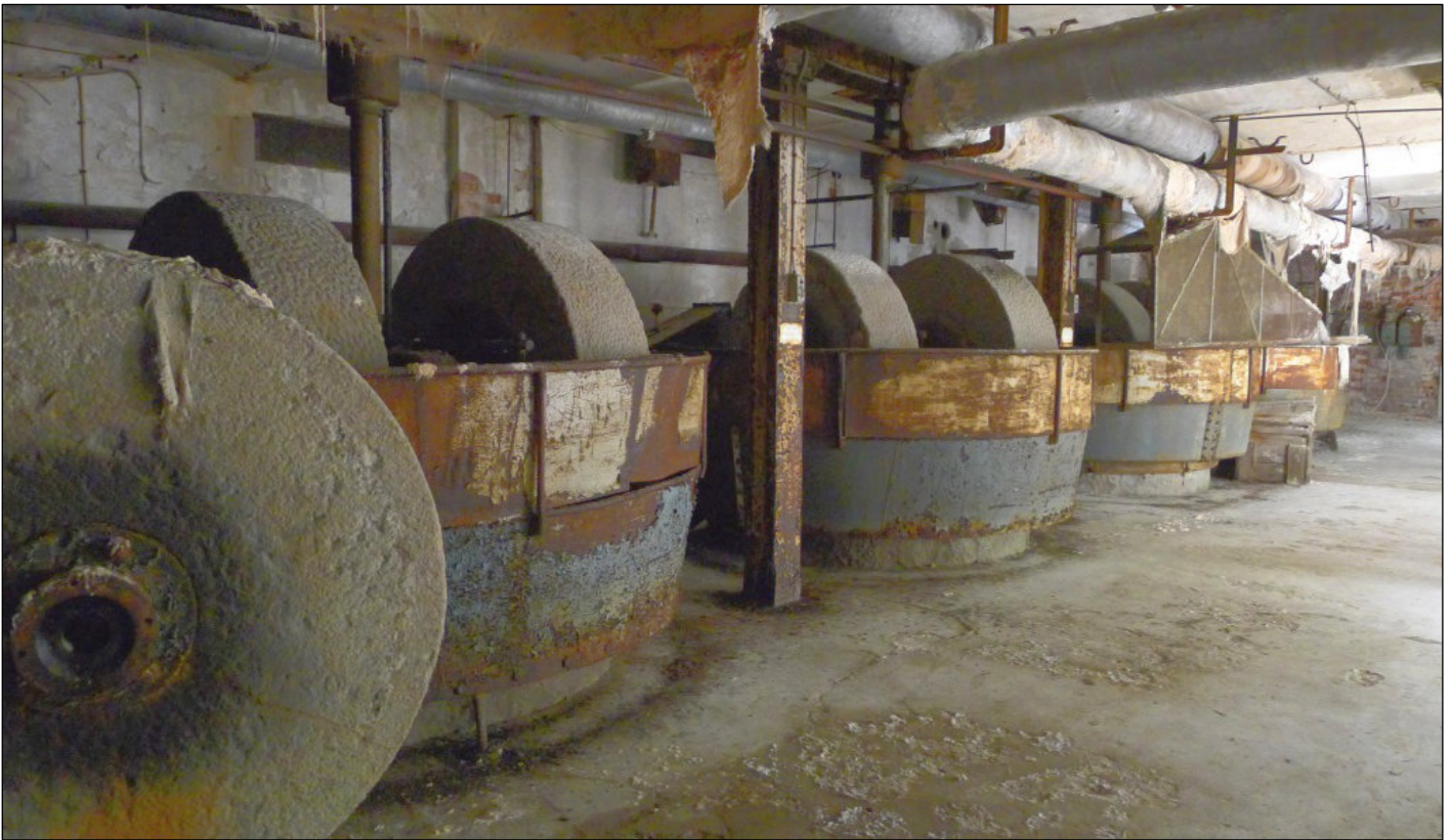
Kollergångar på rad. De användes för att finfördela pappersmassa till mäld. Foto från Wikipedia.
