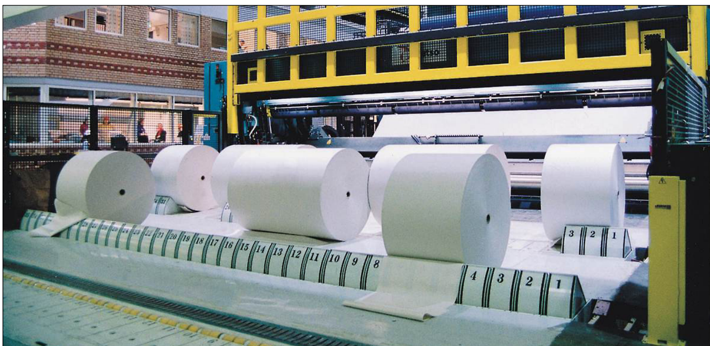
Rullmaskinen och rullar med papper efter köparens önskemål. Foto Håkan Lundén.
