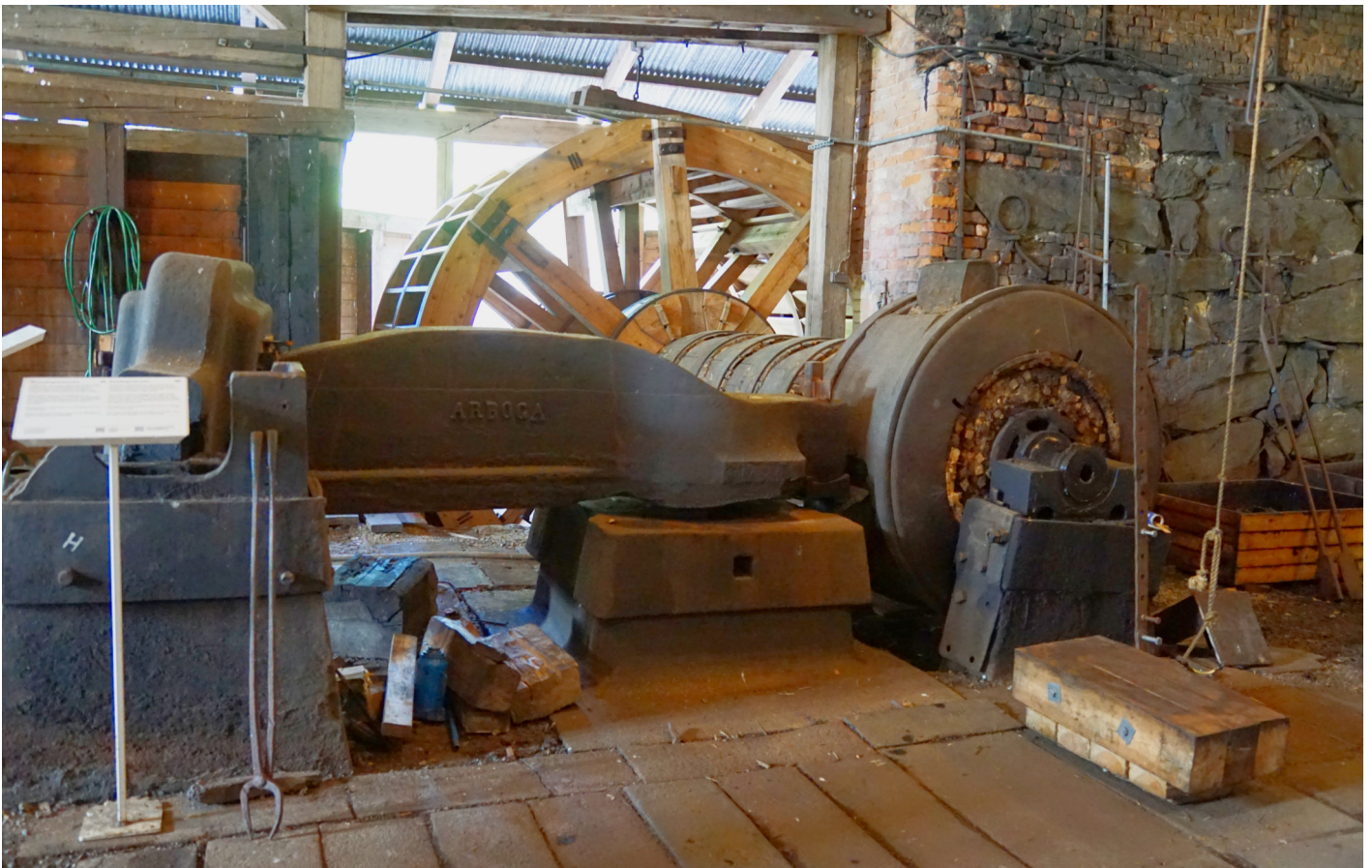
Den stora mumblingshammaren med vattenhjul i Karmansbo Bruk
