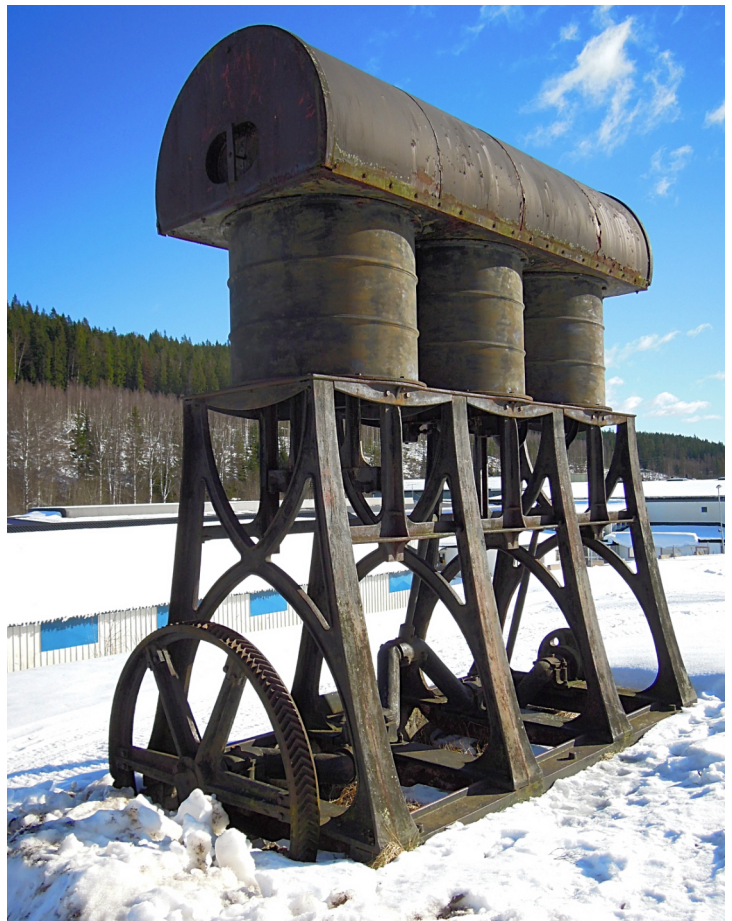
Blåsmaskin av Bagges typ. Patenterades 1841. Bild Wikipedia.
