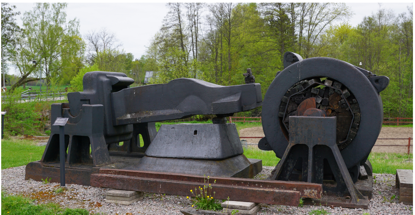
En mumblingshammare. Ett vattenhjul vrider det tandade hjulet till höger medurs och tänderna lyfter hammaren.
